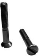
9151 Tornillo M5 x 8 x 34 mm ( sujeta solenoides 7039 / 7050 / 7064 / 7540 / 7550 / 7590 )
