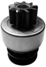
8110/2 Impulsor Z9 derecho L85,50 ø 36 E12 helicoidal (reforzado) Polea de 12 mm 8110/22 Impulsor Z9 derecho L85,50 ø 36 E12 helicoidal (reforzado, modificado) Polea de 8 mm
